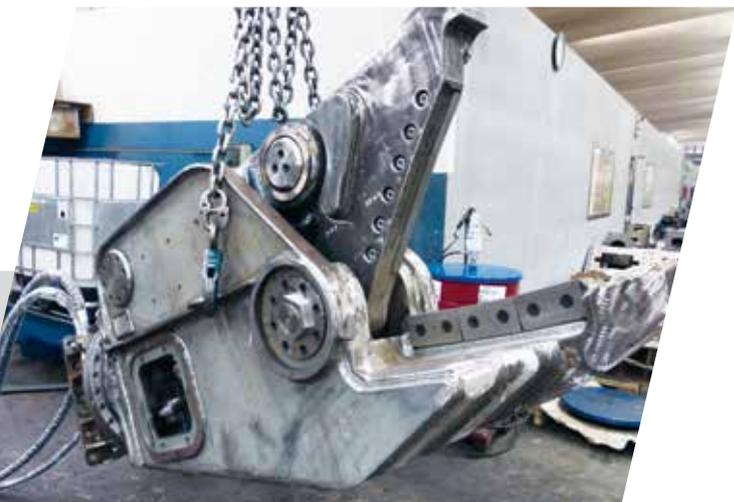
**ITA** - La Pinza Estrattrice è destinata ai professionisti del riciclaggio e commercio di rottami e agli auto-demolitori che operano su auto e veicoli rottamati. Il profilo delle ganasce consente una presa precisa e sicura per asportare i componenti di valore economico maggiore, lasciando il rimanente alla definitiva fase di demolizione nel trituratore o compattatore.
