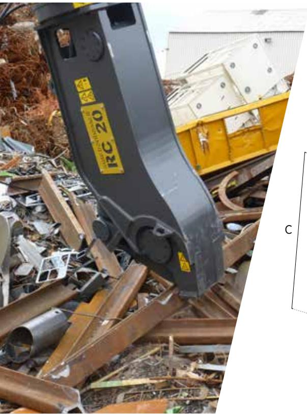
**ITA** - Il Trancia Binari è indicato per chi opera nel settore dei rottami ferrosi per il taglio rapido e produttivo dei binari di ferrovia e tramvia. Sostituisce il costoso sistema tradizionale ossi-taglio manuale. Il profilo specifico e le lame intercambiabili consentono di tagliare le rotaie in modo sicuro, facile e pulito.
