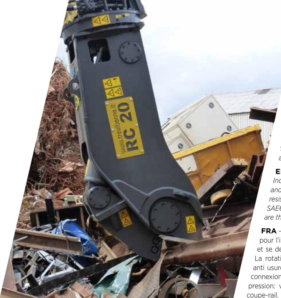
**ITA** - Una linea di attrezzature funzionali ed innovative create per l'industria ferroviaria, appositamente progettate per il taglio e lo smaltimento dei binari di ferrovia e tramvia. La rotazione idraulica continua, l'utilizzo di acciai HARDOX antiusura per sopportare le sollecitazioni del taglio e connessioni idrauliche SAE6000 per sostenere i picchi di pressione sono gli aspetti tecnologici di queste attrezzature trancia-binari.
